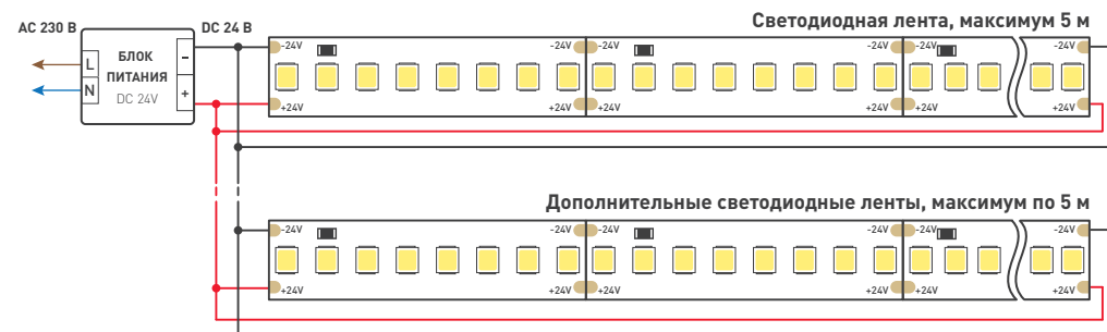
Схема 1. Подключение нескольких светодиодных лент с двух сторон
