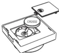
Рис. 1. Установка элемента CR2032 в панель
