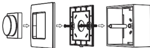
Рис. 2. Установка панели в монтажную коробку
