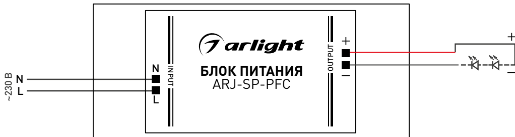
Рис. 1. Схема подключения источника тока
