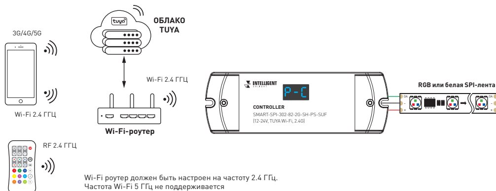
Рис. 3. Общая структурная схема построения системы управления освещением
