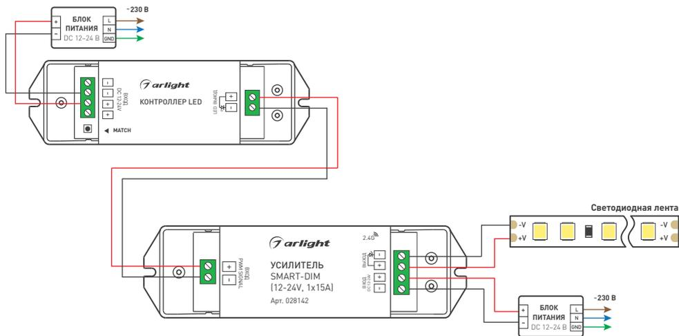
Рисунок 1. Схема подключения усилителя SMART-DIM
