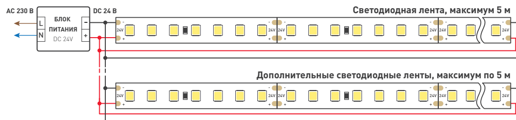
Рис. 2. Подключение нескольких светодиодных лент с двух сторон
