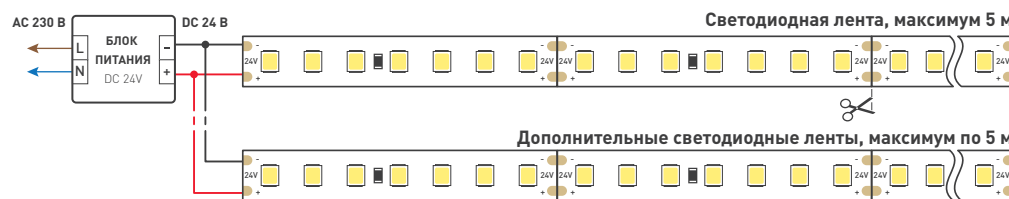
Рис. 1. Подключение нескольких светодиодных лент с одной стороны
