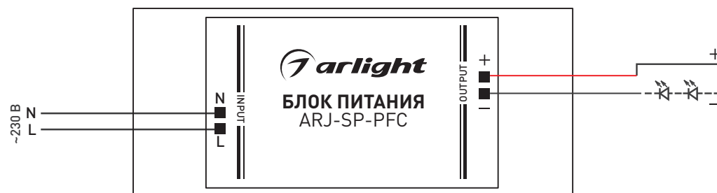
Рис. 1. Схема подключения источника тока
